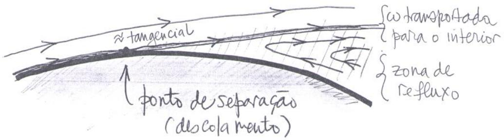
Segundo o Batchelor (pg.328) o ponto de separação está muito próximo ao ponto de velocidade máxima da linha de corrente externa da camada. Observa-se também que este ponto está próximo ao ponto de tensão cisalhante nula (um ponto singular em termos de esforços friccionais).
